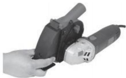
3. Nasadte kryt na úchytku brúsky a potom pomocou imbusového kľúča utiahnite objímku tak, aby kryt pevne držal.
